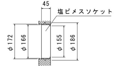
排水ピット (止水栓) 詳細図
