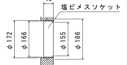
排水ピット(止水栓)詳細図 ※S=1/10
