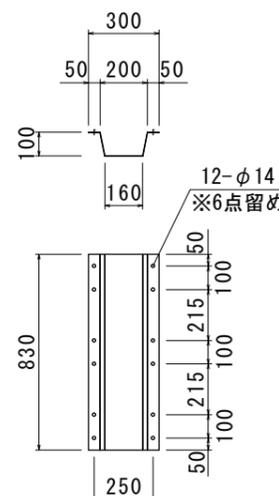
スクリーン槽, 吸着槽 隔壁板 SUS t=1.5
